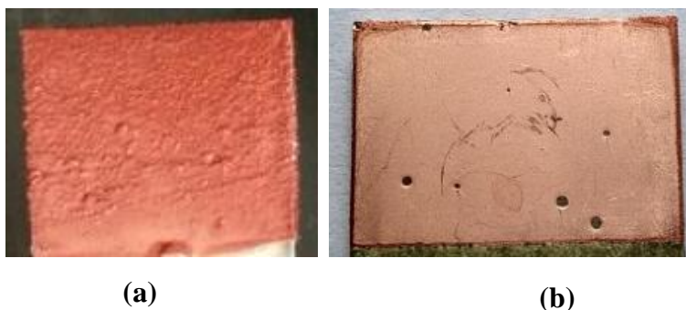
Gambar 2. Foto makro endapan tembaga pada variasi konsentrasi Cu (a) 0,04 M dan (b) 0,8 M serta pada rapat arus 2 \text{ A/dm}^2 .
