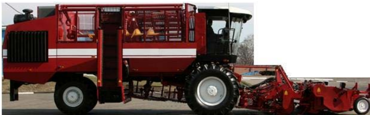
Рис. 2. Пример универсального самоходного шасси по схеме 4К4 в составе свеклоуборочного комбайна Fig. 2. Example of universal self-propelled chassis according to scheme 4K4 including sugar beet harvester
