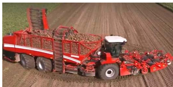
Рис. 1. Пример универсального самоходного шасси по схеме 6К6
