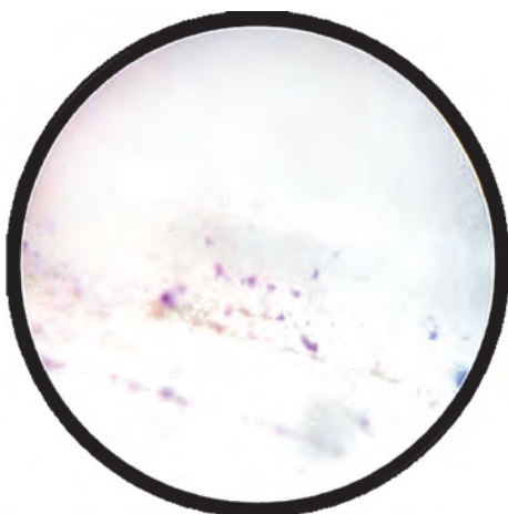
Рис. 6. Адгезія золотистого стафілокока до поверхні поліуретанового катетера, 48 годин ( \times 900 )
