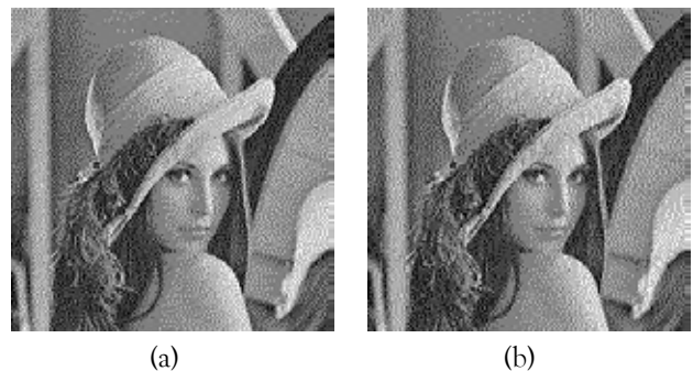
Figura 8. Método de difusión de error por Floyd-Steinberg. (a) Raster (b) Serpiente
