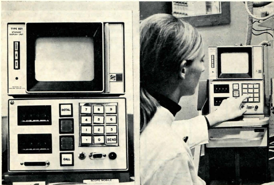
Abb. 6. Periphere Station („Computer-Terminal“) bestehend aus einem Speicheroszillogoskop (oben) zum Ausschreiben der Daten, Fragen und Kontrollmeldungen sowie Kurvenzüge und einem Tastenfeld zur Befehlseingabe sowie zum Anrufen und Steuern der Programme. Links: zwei Oktalschalter, Mitte: zwei Oktaltasten zum zugehörigen Schalter und zwei Kontrolllampen. Runder Knopf: zum Anzeigen der analogen Ekg- und Druckkurven. Rechts: Tastenfeld zum Eintasten des 4-Ziffern-Codes (Programmspezifikation).
