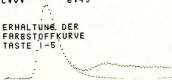
Abb. 14. Typische Anzeige der aus der Farbstoffkurve berechneten Größen in digitaler Form sowie der Originalkurve mit der überlagerten, exponentiellen extrapolierten Abfallkurve, die der Berechnung der Werte zugrunde liegt und eine sofortige Beurteilung der Brauchbarkeit der Kurve und Güte der Extrapolation erlaubt. (CO = Herzzeitvolumen, MI = Mitralindex, AT = Erscheinungszeit, BT = Konzentrationszeit, CV = zentrales Blutvolumen, MT = mittlere Zirkulationszeit).
