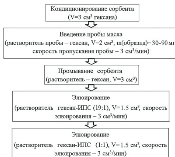
Рис. 2. Схема пробоподготовки методом ТФЭ.
