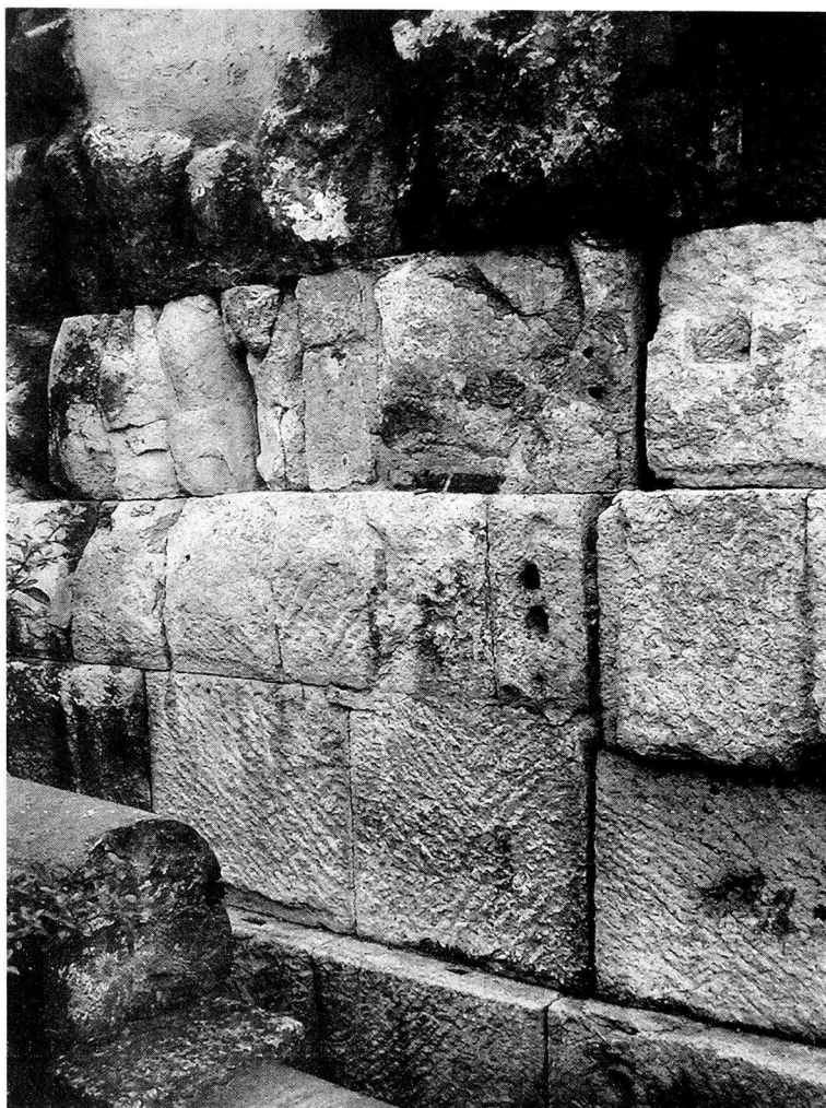
62: Musterfeld MF1 zur Reinigung nach der Applikation einer kombinierten Reinigungsvariante auf der Ostseite des Turmes der porta praetoria (2002).
