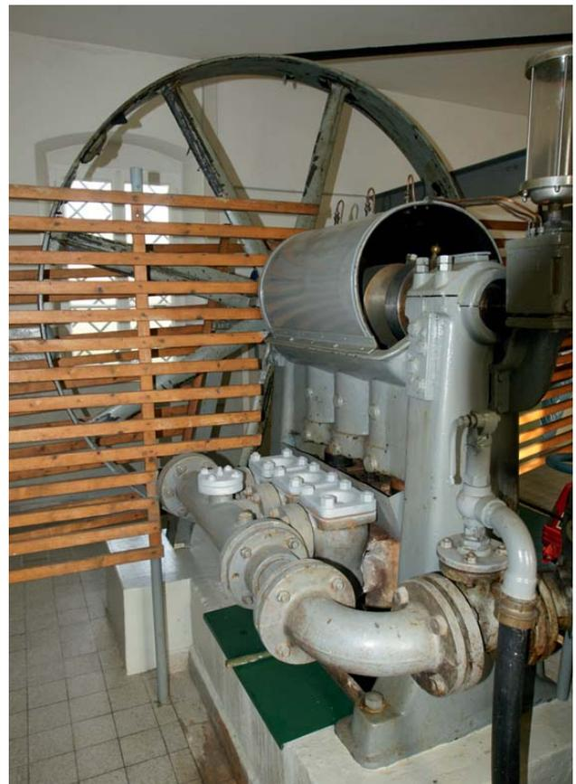
Abb. 67: Amag-Hilpert-Kolbenpumpe
