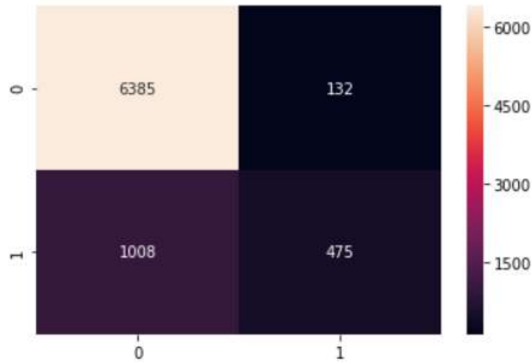
Figura 72. Matriz de confusión de la Máquina de Vector de Soporte con datos sintéticos
