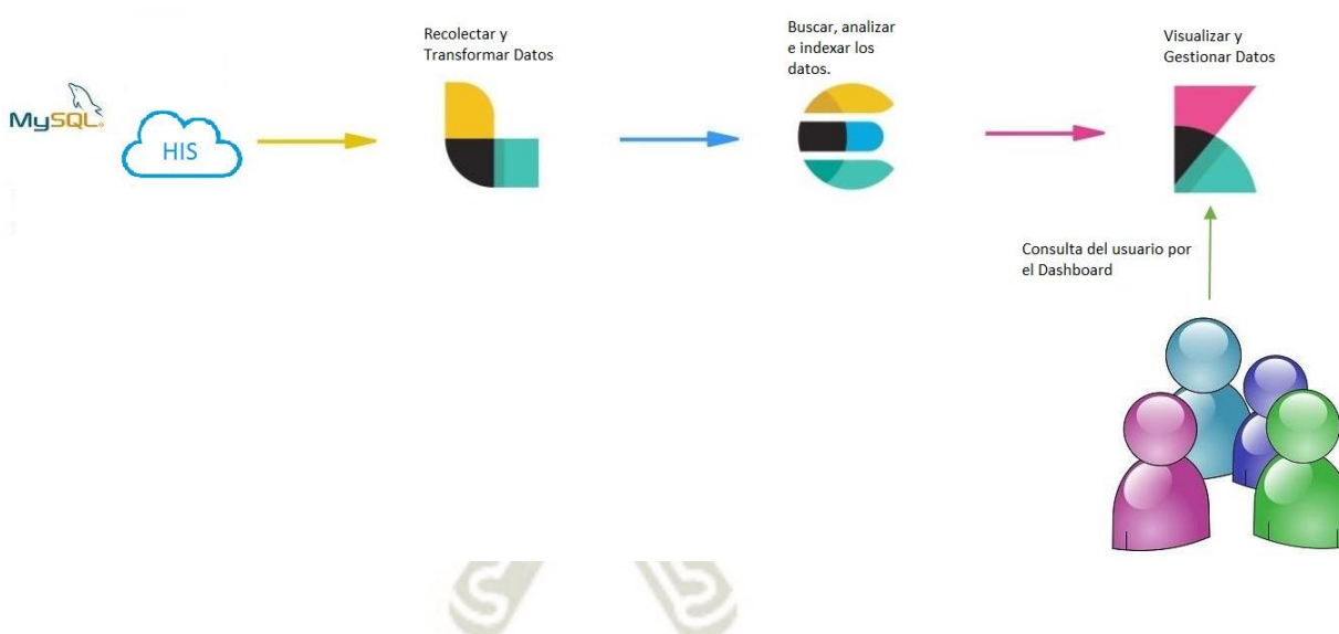
Figura 1.3: Análisis de datos de extremo a extremo en ELK Stack
