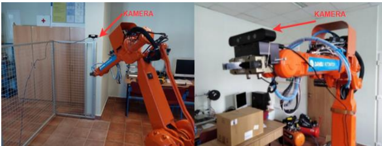
Slika 2.10. Pozicije kamere za vizualni servoing
