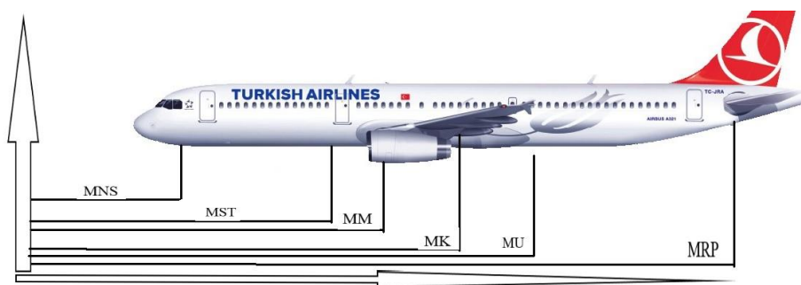
Slika 5. Analitičko – matematička metoda za prazan zrakoplov
