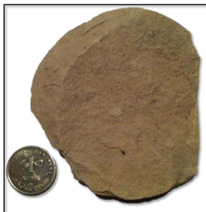
Slika 7.20. Lapor iz bušotine B-3, dio jezgre 1
