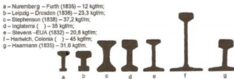
Figura 9 - Evolução do perfil dos trilhos - Perfil para "apoios contínuos"
