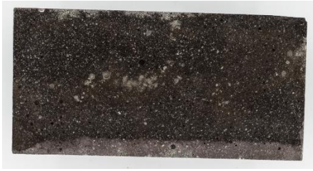
Figura 6 – Profundidade de penetração de cloretos (parte mais clara) de um provete de UHPC após o ensaio de migração em regime não estacionário.
