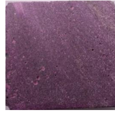
Figura 7 – Provete UHPC não carbonatado após 3 meses de exposição a CO 2 (5±0.1%).
