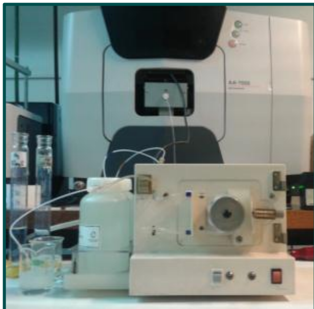
Figura 5: Equipo de absorción atómica Shimadzu AA 7000 con acoplamiento de generador de hidruros utilizado en la determinación de mercurio.
