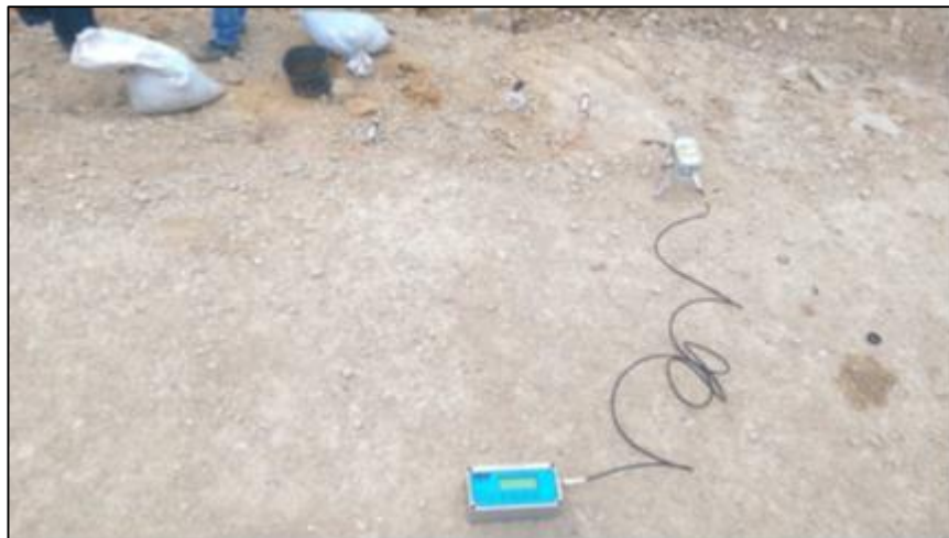
Figura 16. Sismógrafo Instantel Junto con el Geófono Triaxial (Interno) y el Micrófono de Alta Sensibilidad
