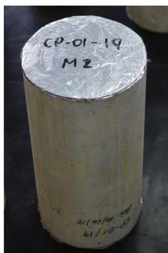
Figura 9.1 Colocación y sellado de la muestras para ensayo
