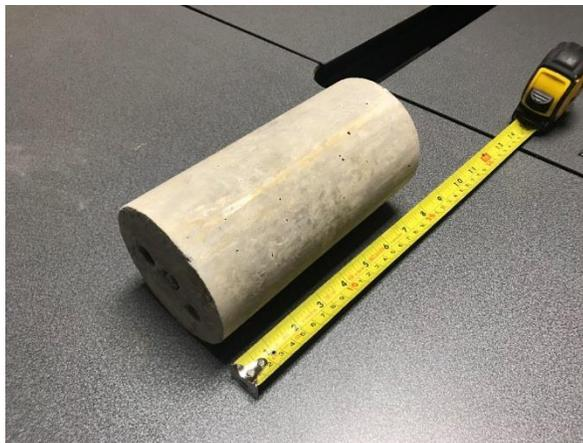
Figura 7.9. Especímenes cilíndricos de concreto de diámetro 10 cm y altura 20 cm.
