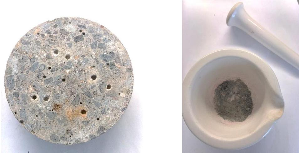
Figura 7.5 Extracción y preparación de las muestras para análisis difractométrico y TGA.
