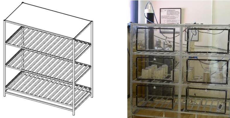
Figura 8.3 Esquema de diseño de la cámara de carbonatación
