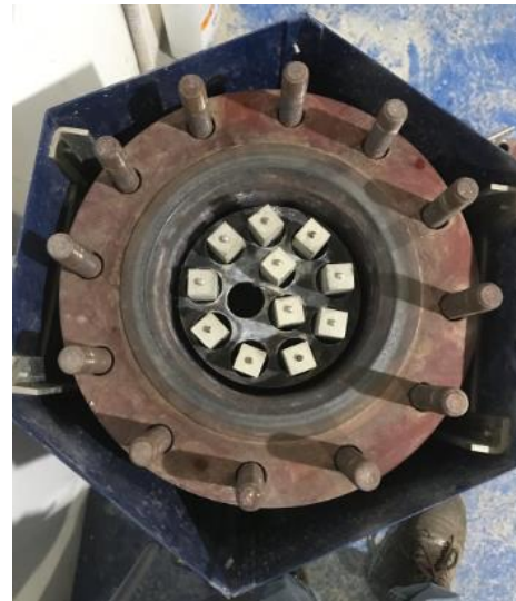
Fotografía 7. Probetas de pasta de cemento dentro del Autoclave. Pevio a la ejecución del ensayo.
