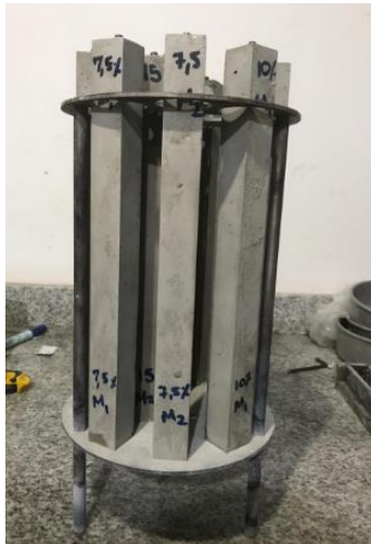
Fotografía 6. Colocación probetas de ensayo en disco de ruptura.
