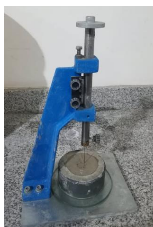
Fotografía 4. Ensayo tiempos de fraguado para 0% de sustitución en aparato de Vicat.
