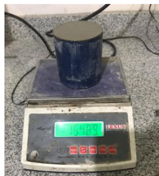
Fotografía 9. Pesaje de mortero en molde para ensayo de contenido de aire.
