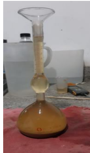
Fotografía 8. Densidad de la cerámica en frasco de Lechatelier
