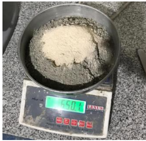
Fotografía 1. Pesaje masa de cemento al 85% y de polvo cerámico al 15%
