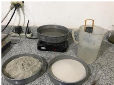
Fotografía 2. Preparación de materiales para fabricación de cubos de mortero
