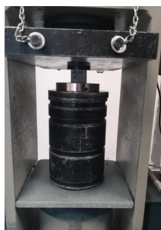
Fotografía 3. Compresión de cubos de mortero 0% de sustitución para el día 3
