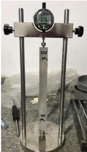
Fotografía 5. Medición barra de pasta de cemento para ensayo de autoclave.
