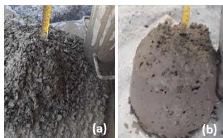
Figura 7. Mezcla segregable (a), mezcla no segregable u homogénea (b)
