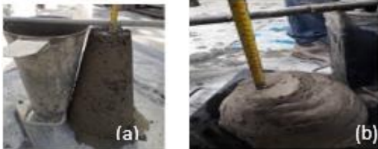
Figura 8. Asentamiento inicial sin aditivo (a), asentamiento final con aditivo (b)
