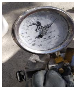
Figura 10. Contenido de aire método por presión del hormigón en estado fresco.
