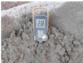
Figura 9. Ensayo de temperatura del hormigón en estado fresco.
