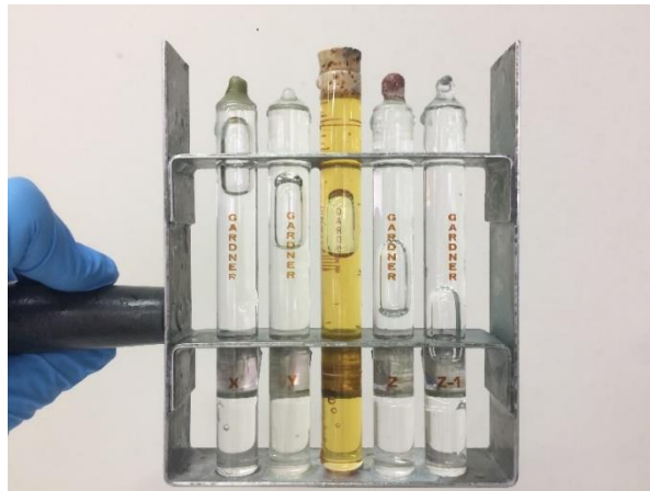
Figura 3.5. Determinação da viscosidade Gardner de uma resina alquídica.
