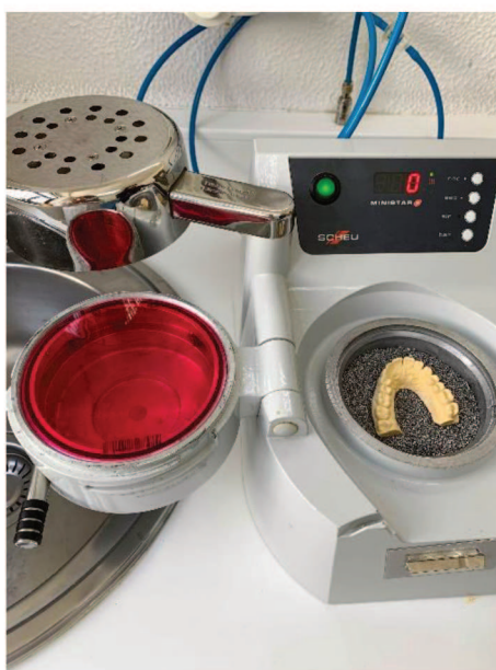
Figura 4. Scheu Ministar® para confecção do BruxChecker® com modelo de trabalho e película nos locais indicados
