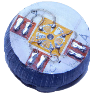
(b) Applizierte Rosette auf Rastegaev-Stauchprobe nach dem Stauchvorgang
