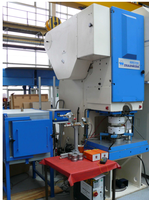
Abbildung 5.5: Verwendeter Experimentierstand an der Professur Virtuelle Fertigungslehre mit Doppelständer-Exzenterpresse PED 100.3-S4 (rechts) und einem Kammerofen (links) [5]
