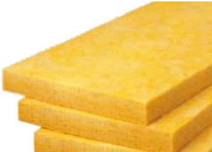
**Fig. 13** Lane minerali: lana di roccia (sopra); lana di vetro (sotto)
