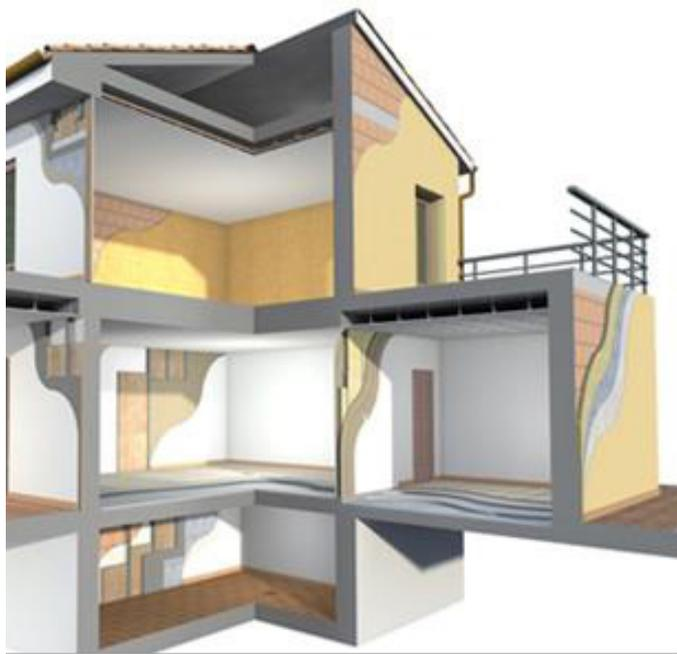
**Fig. 2 Isolamento dell'involucro e delle partizioni interne**
