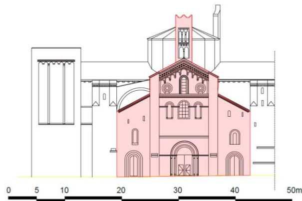
Figure 4.13. Overturning of the main façade of La Seu d'Urgell (SU1)
