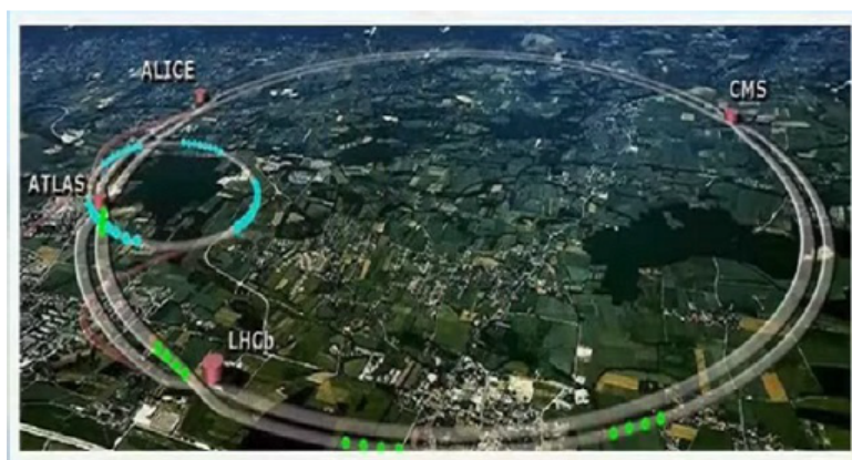
Figure 2.1: Αεροφωτογραφία του ευρωπαϊκού κέντρου έρευνας στην φυσική στοιχειωδών σωματιδίων (CERN). Στη φωτογραφία απεικονίζονται σχηματικά τα τούνελ στα οποία επιταχύνονται οι δέσμες καθώς και τα τέσσερα σημεία στα οποία βρίσκονται οι ανιχνευτές. Όλες οι διατάξεις βρίσκονται 100 μέτρα κάτω από την επιφάνεια της γης.
