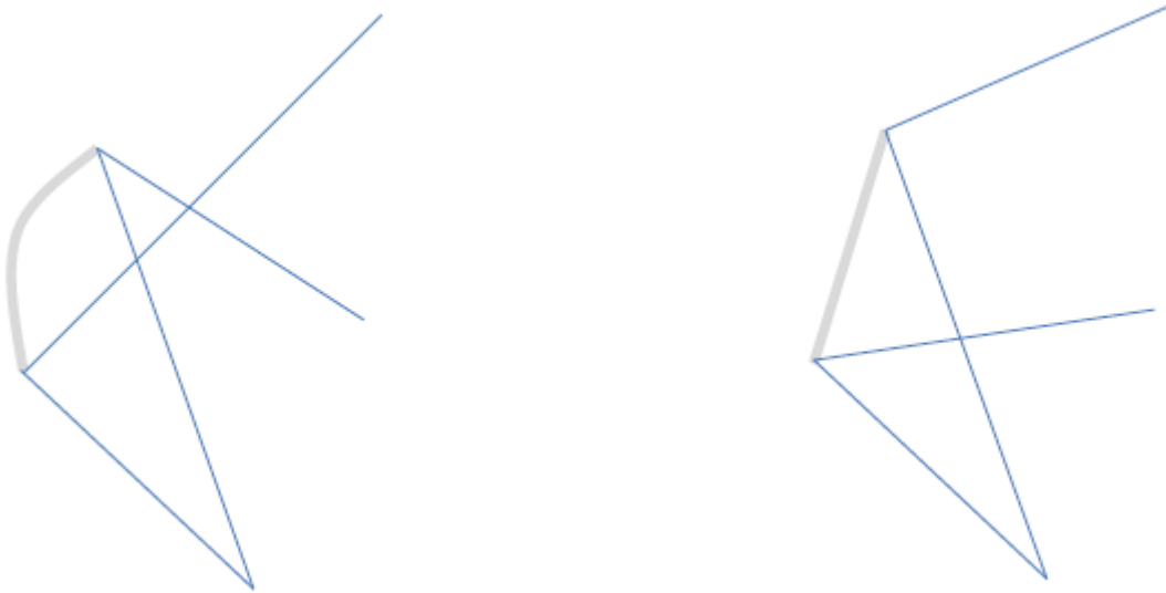
Abbildung 7: Krümmung des Facettenreflektors. Je nach Gestaltung des Facettenreflektors verlassen entweder konvergierende Strahlenbündel (Abbildung links) oder divergierende Strahlenbündel (Abbildung rechts) die Anordnung [7].
