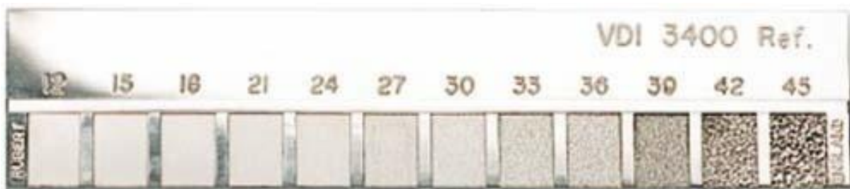
Abbildung 2: Referenzmusterplatte nach VDI 3400 [4]
