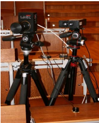
Abbildung 2: Messaufbau. Leuchtdichtkamera LMK 5 color (links), Radiospektrometer und Beleuchtungsstärkemessgerät für E_v (rechts), sowie für E_h auf
