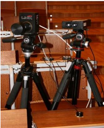
Abbildung 2: Messaufbau. Leuchtdichtekamera LMK 5 color (links), Radiospektrometer und Beleuchtungsstärkemessgerät für  $E_v$  (rechts), sowie für  $E_h$  auf
