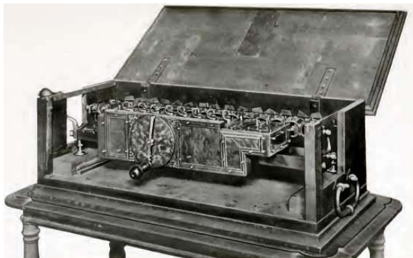
Abbildung 3.7: Rechenmaschine von Gottfried Wilhelm Leibniz (1646–1716). Es handelt sich um die erste Vier-Spezies-Rechenmaschine.
