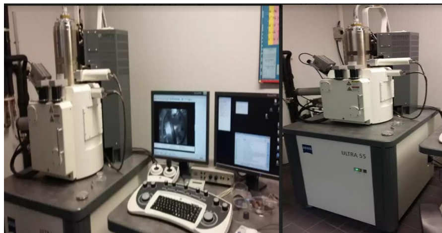
Fig. 14. SEM test equipment.
