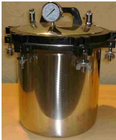
Figura 1. Autoclave Eléctrico Arcano de 16 litros.
