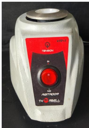
Figura 6. Agitador de tubos tipo Vórtex. Marca Th-Rbell.
