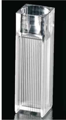
Figura 8. Cubeta para espectrofotómetro Thermo (electron corporation) modelo Heλios.
