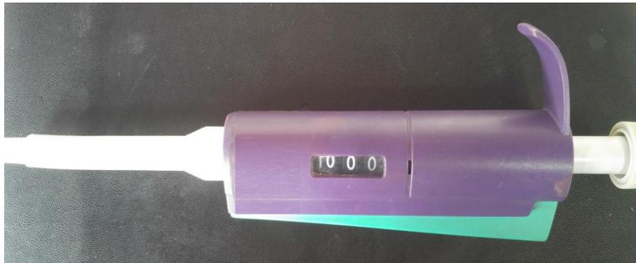
Figura 13. Pipeta automática Marca Eppendorf con una capacidad máxima de 1000 ul.
