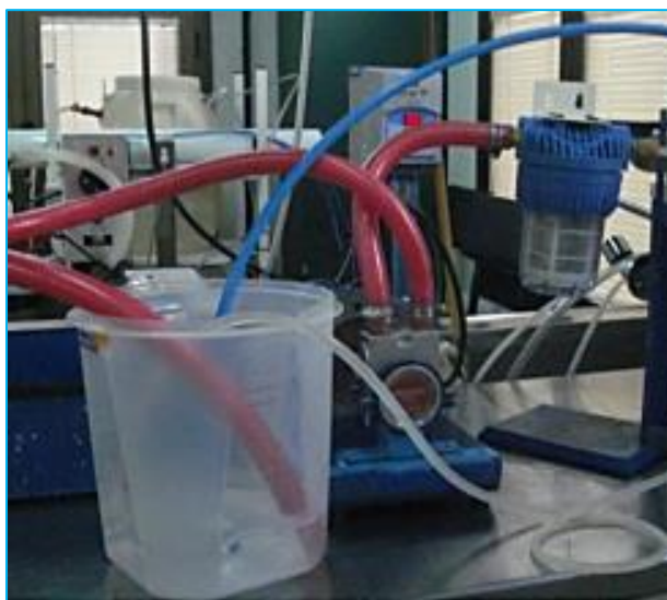
Figura 3.7: Equipo de microfiltración frontal, empleado en el descremado de leche cruda.
