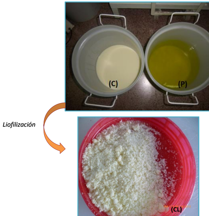
Figura 3.12: Permeado (P) y concentrado (C) obtenido al finalizar el proceso de UF. Concentrado de UF, liofilizado (CL).
