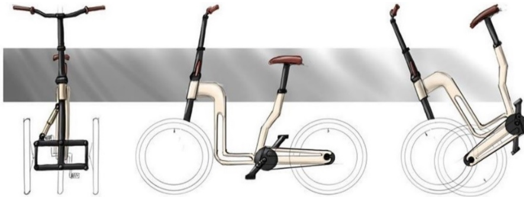
Figura 3.10: Esquema de dobragem do conceito Ghisallo. [3]
