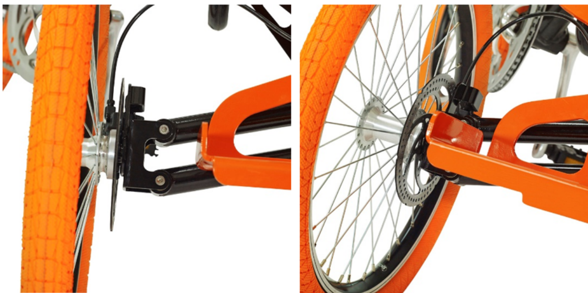
Figura 2.10: Direção pendular da eKiffy. [29]
