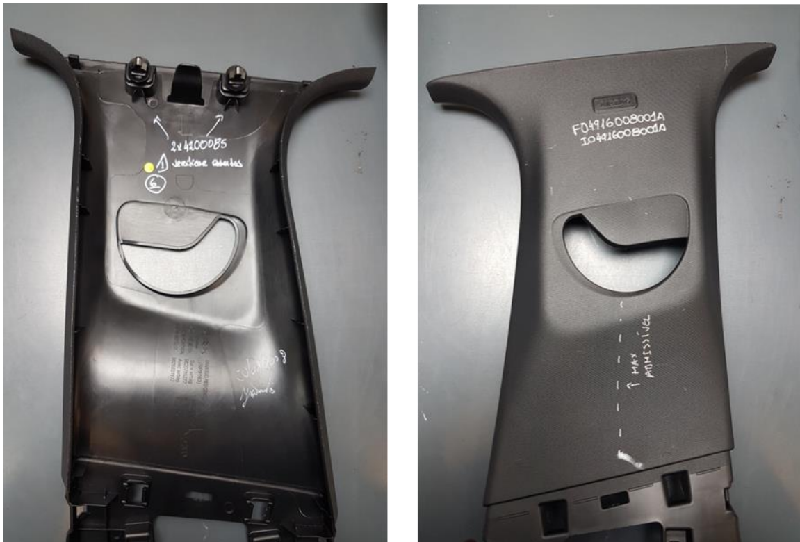
Figura 11 - Peças padrão, parte visível e parte técnica
