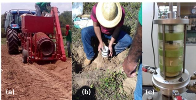
**Figura 2.** Detalhe dos ensaios realizados para as definições das condições de contorno para o projeto da colhedora de Amendoim Forrageiro. a) Ensaios de colheita de sementes com o protótipo, b) Amostras indeformadas de solo para a granulometria e ensaios de resistência c) Ensaios de compressão tri axiais em mecânica dos solos.
