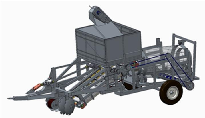
**Figura 5.** Vista em perspectiva do modelo em CAD gerado na documentação do protótipo.
