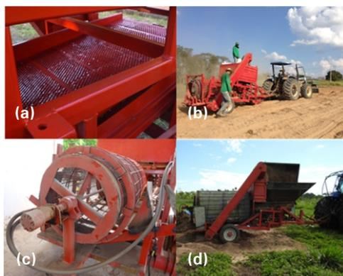
**Figura 6.** Histórico de desenvolvimento do protótipo da colhedora a) 2001 a 2011; primeiro protótipo com sistema de separação das sementes por peneira horizontal vibratória. b) 2014 a 2015; o sistema de separação foi substituído por peneiras cilíndricas acionadas por roldanas. c) 2016; o acionamento foi substituído por um eixo central d) 2017 a 2018; o sistema de alimentação por esteira raspadora foi substituído por um alimentador por helicóide.
