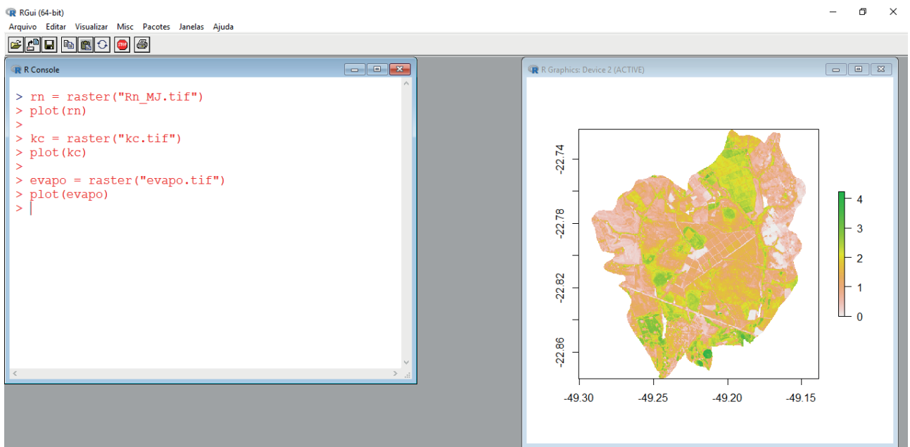
Figura 43. Visualização da evapotranspiração real gerada pela função evapo_18() do pacote Agriwater no R usando imagens Landsat-8.
