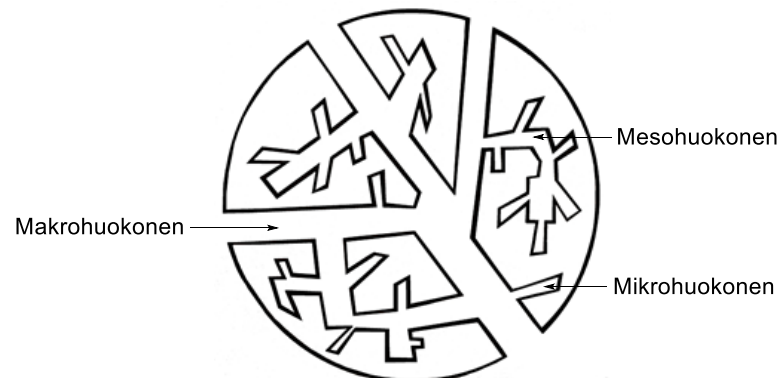
Kuva 9. Aktiivihiilen mikrorakenne. Kuva on tehty aineiston perusteella. 22
