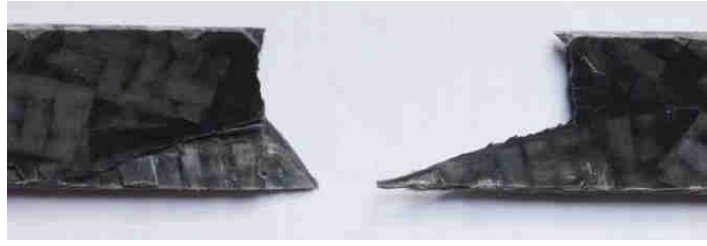
Figure 7. Faciès de rupture d'une éprouvette de traction extraite d'une plaque composite fabriquée à partir de grains rectangulaires.
