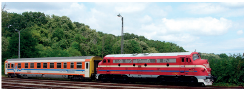
1. kép. MÁV Központi Felépítményvizsgáló Kft. FMK-007 jelű lézeres vágánygeometriai mérőkocsija (balra) (Forrás: MÁV KfV Kft.)
