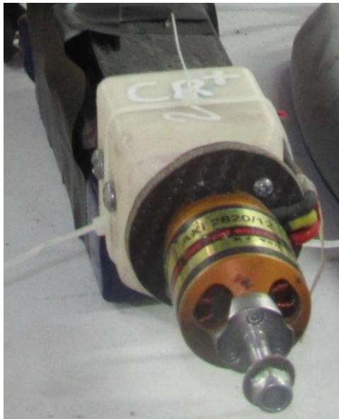
Ilustración 10: Motor AXI 2826/12 Gold Line instalado en la RPAS
