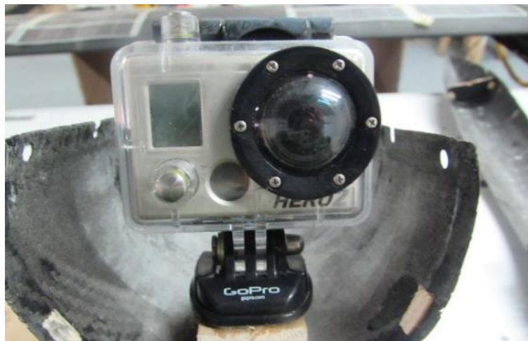
Ilustración 7: Cámara GoPro Hero 2 instalada en el fuselaje del VANT
