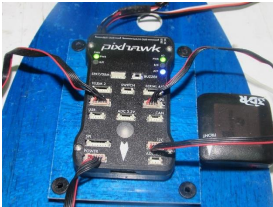
Ilustración 4: Sistema de Piloto Automático Pixhawk instalado en la RPAS VANT Solvendus
