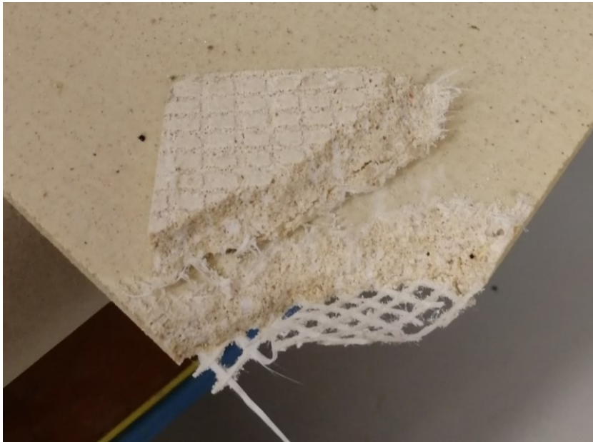
Kuva 34 Materiaali A kosteudensietotestin jälkeen
