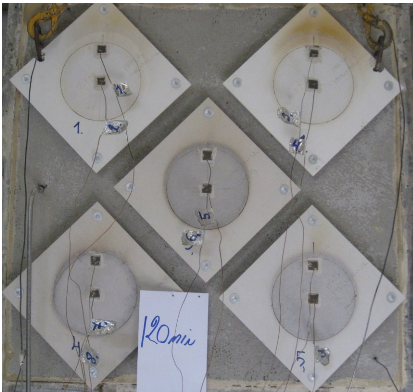
Kuva 19 Palotesti 1 tilannekuva kahden tunnin kokeen jälkeen
