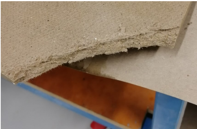
Kuva 36 Materiaali R kosteudensietotestin jälkeen
