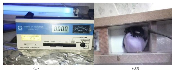
شکل ۱. الف) نحوه قرارگیری موش ها در جمیع تابش دهی UVB (ب) لامپ UVB و دتکتور تابش امواج فرابنفش
