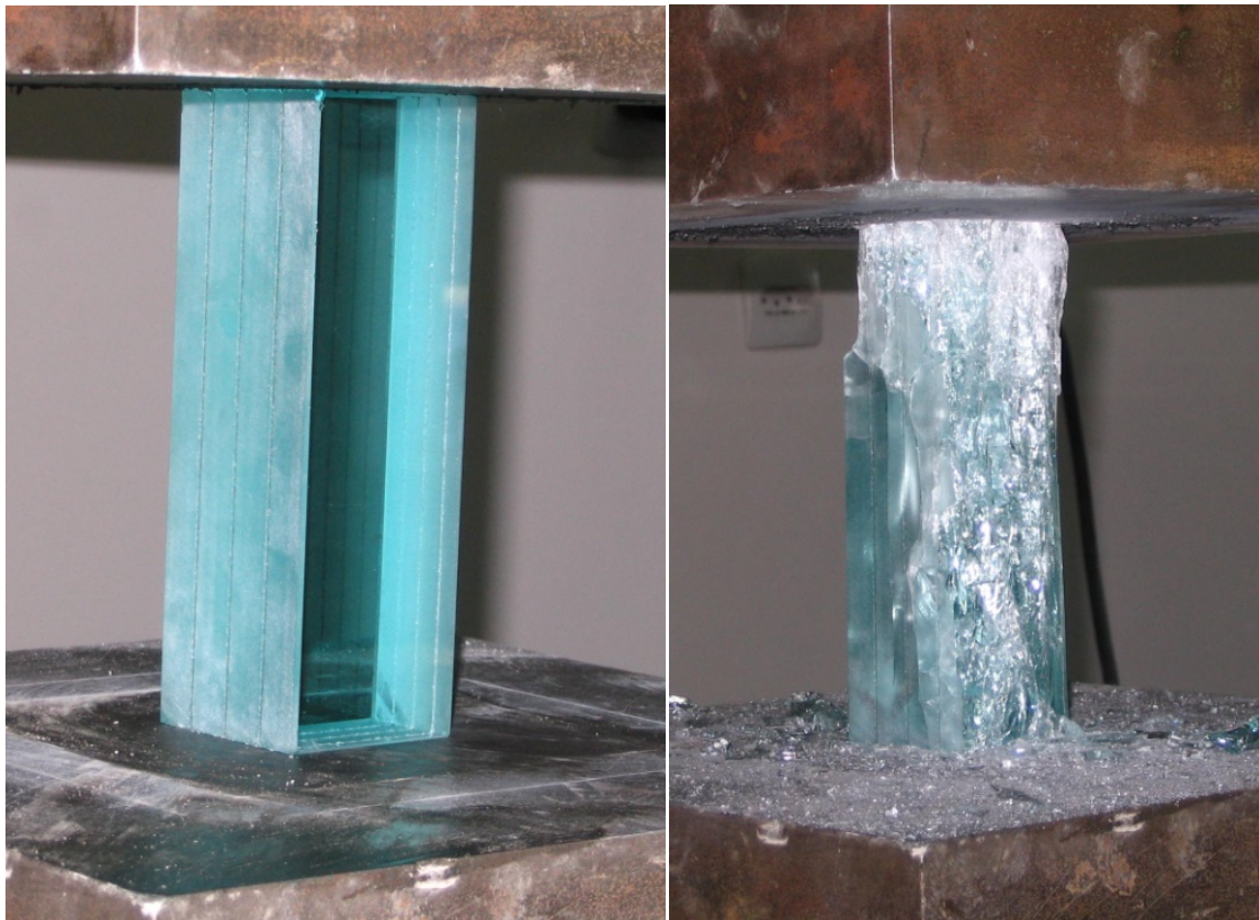
Слике 3.4.1 и 3.4.2: ламелирано стакло – узорак на почетку испитивања чврстоће при притиску и исти узорак на крају испитивања – у фази лома
