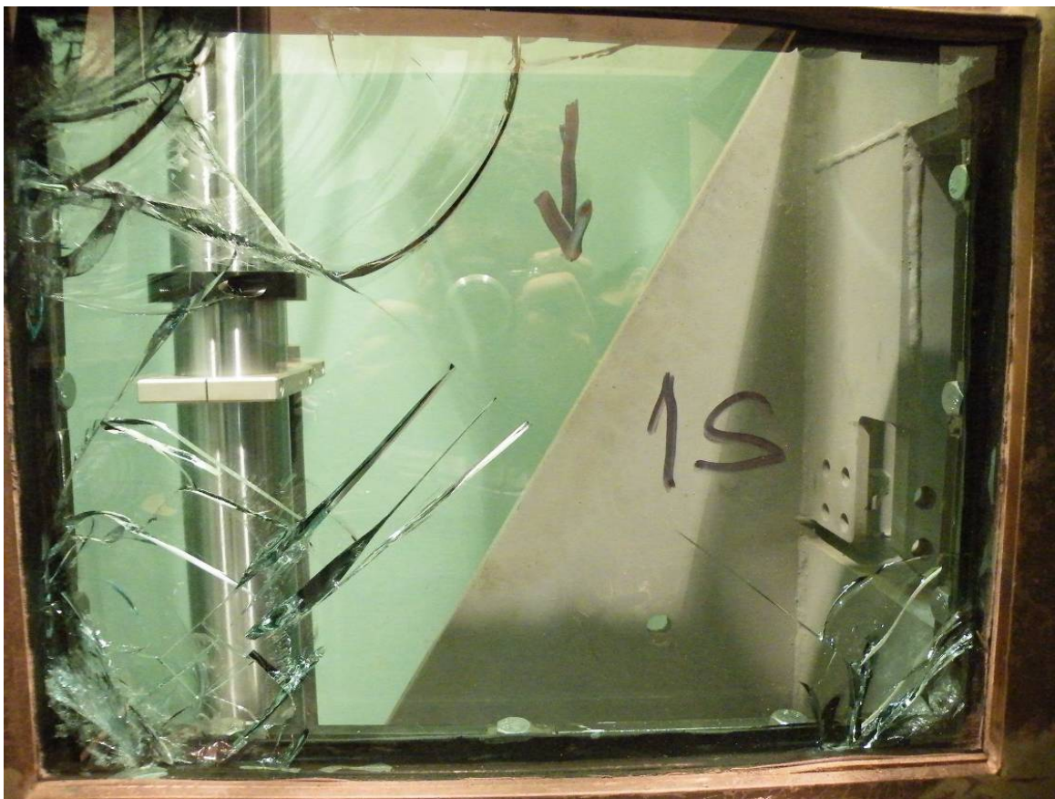
Слика 4.4.10: експериментални панел након испитивања (поглед са леве стране)
