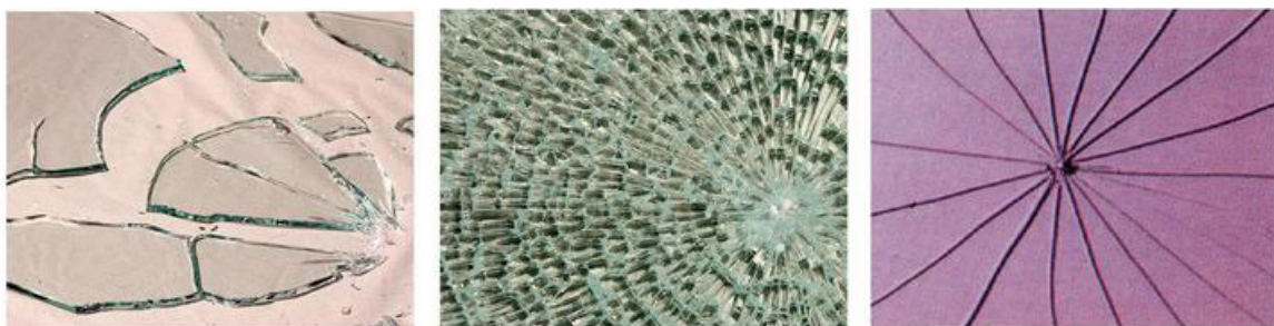
Слика 2.1.4: поређење начина лома обичног, потпуно каљеног и делимично каљеног стакла 15
