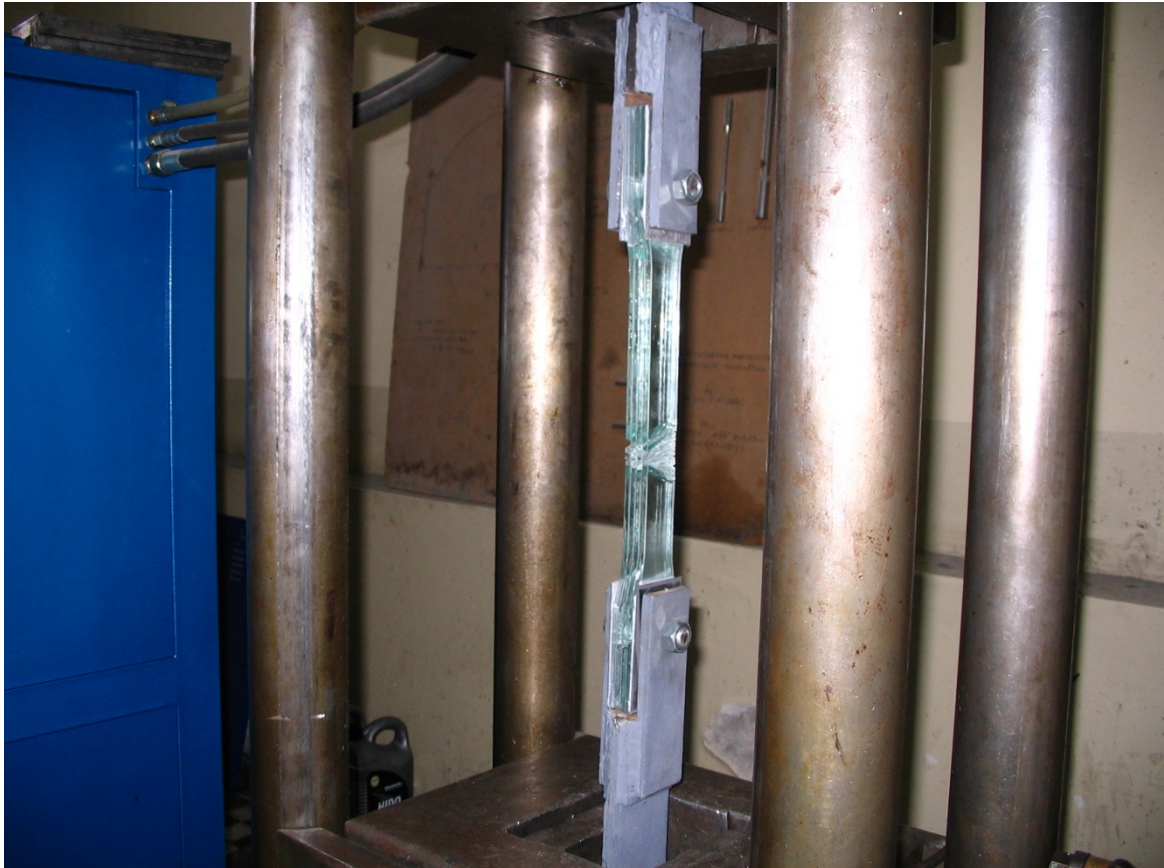
Слика 3.6.4: испитивање ламелираног стакла на “чисто” затезање – лом око средине узорка - епрувете
