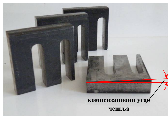
Слика 4.3.11: Конусни чешљеви за компензацију угла нагиба профила испитног панела
