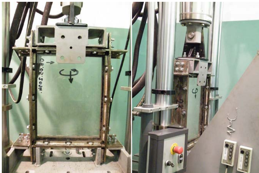
Слика 4.4.22: Положај експерименталног панела у прихватном алату и изглед самог алата за испитивање увијањем
