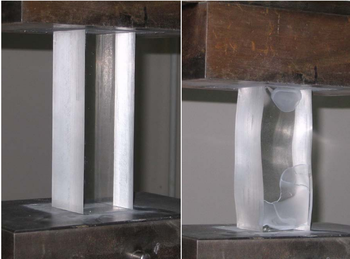
Слике 3.4.3 и 3.4.4: ламелирани клирит – узорак на почетку испитивања чврстоће при притиску и исти узорак на крају испитивања – у фази лома
