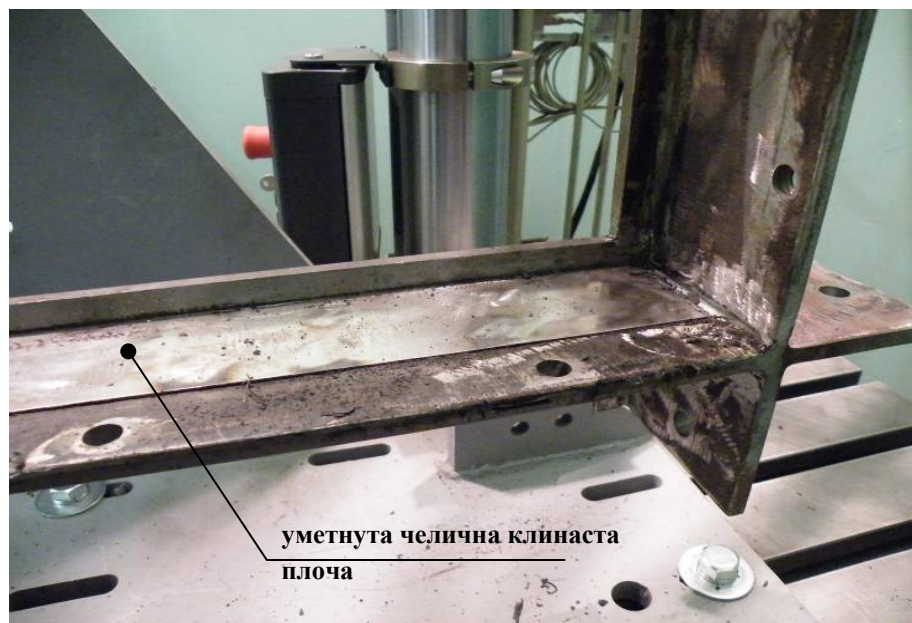
Слика 4.4.16: Уметнута клинаста плоча за постизање равномерне расподеле оптерећења
