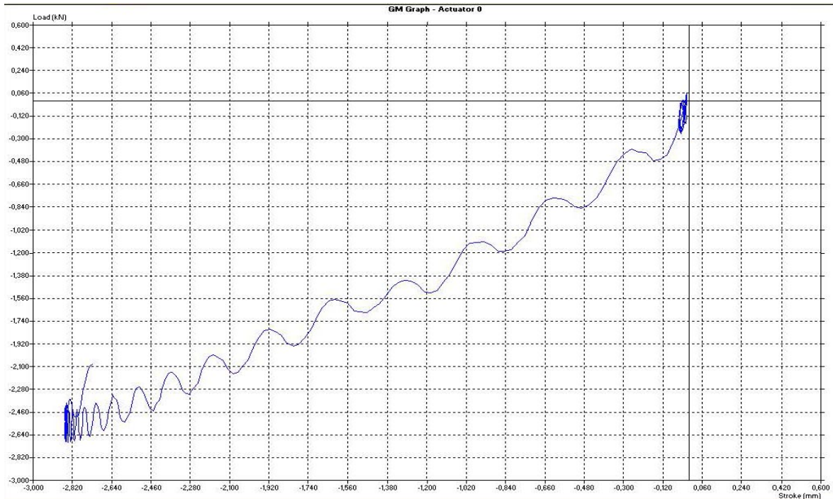
Слика 4.4.4: пробно статичко испитивање панела, оптерећење 2.5 kN (дијаграм: сила / деформација)
