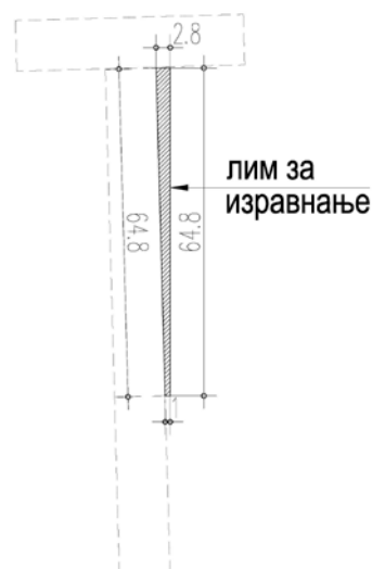
Слика 4.2.7: положај лима за изравнање, који се лепи за ребро вертикале челичног рама – детаљ хоризонталног пресека
