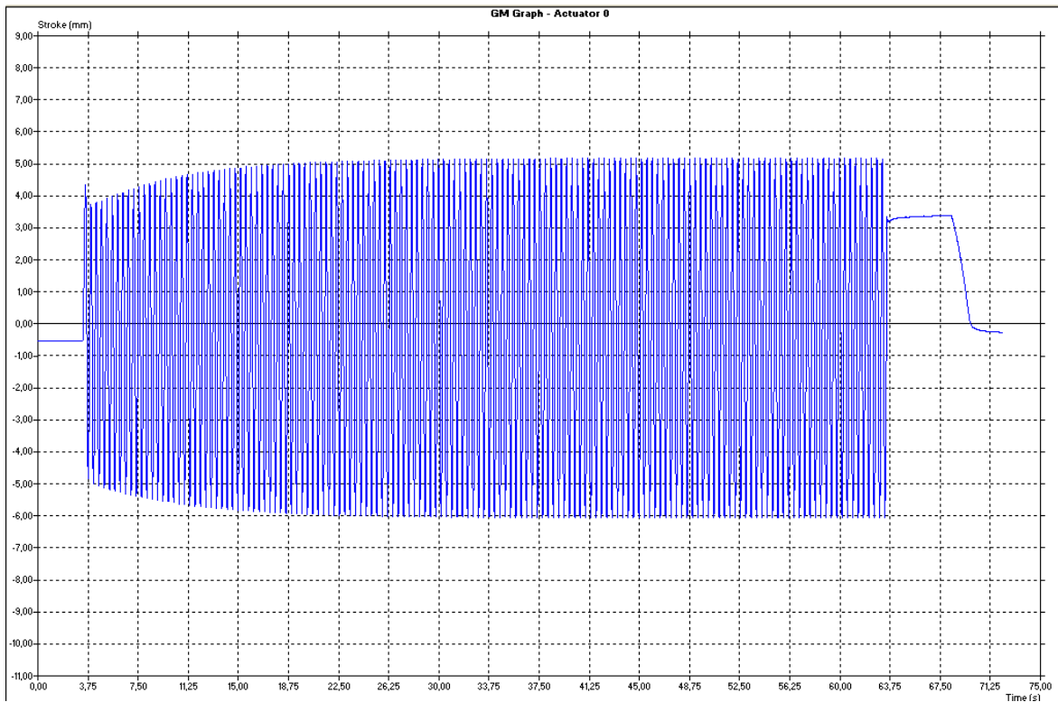
Слике 4.4.52 и 4.4.53: Динамичко испитивање панела са испуном од клирита \nu_4 = 2,6 \text{ Hz} , F_D = 22 \text{ kN} , 150 циклуса
