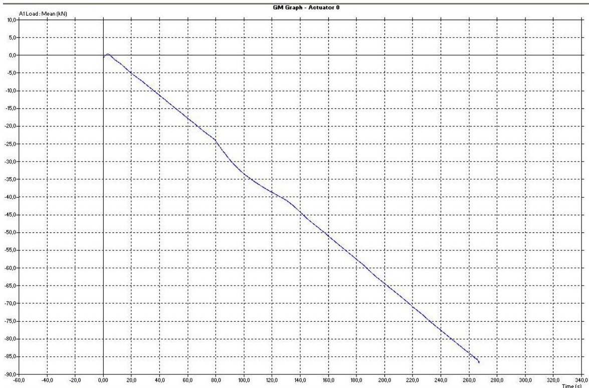
Слика 4.4.7: пробно статичко испитивање притискавањем, оптерећење 86 kN (дијаграм: сила / време)
