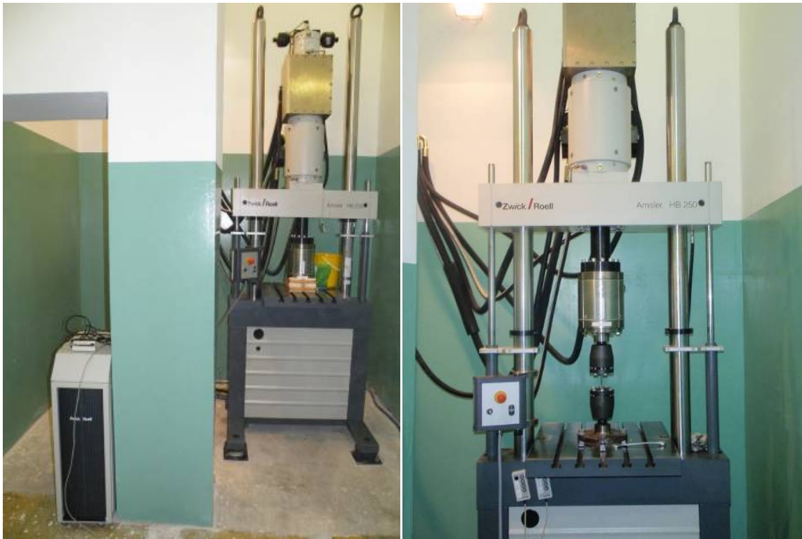
Слика 4.3.2: серво хидраулична машина за динамичко и статичко испитивање материјала ZWICK Roell HB – 250
