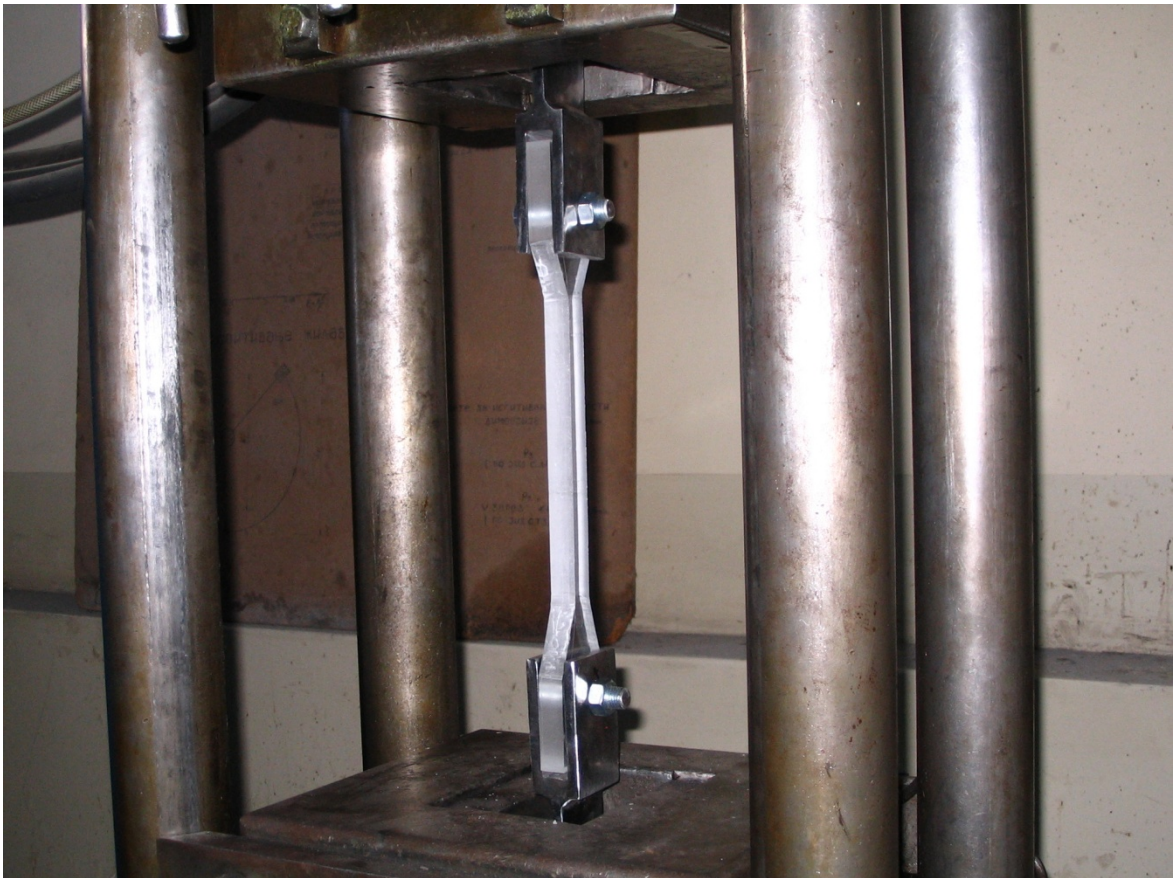
Слика 3.6.2: испитивање чламелираног клирита на “чисто” затезање
