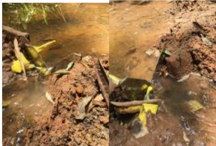
Figura 4. Tipo de vertedor utilizado e a água formando um “véu de noiva” ao extrapolar.
