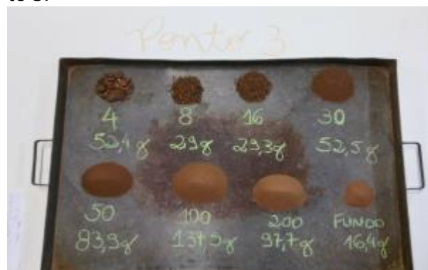
Figura 7. Tamanhos de peneiras utilizadas e seus respectivos pesos finais de solos no ponto 3.
