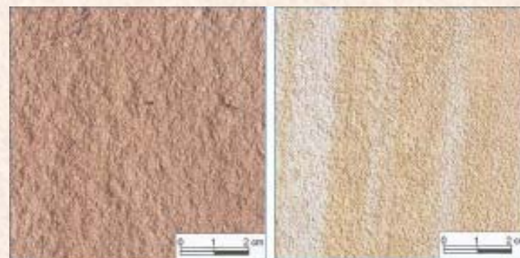
Muestras escaneadas (izq.: laja rosada y der.: laja con anillos de Liesegang)
