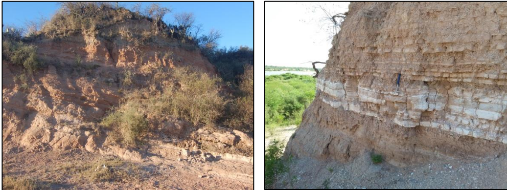
Figuras 6.6 y 6.7. Detalle de la alternancia de materiales de diferentes competencias: limos y arcillas consolidadas blandas y niveles areniscosos moderadamente duros y competentes.
