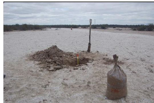
Figura 6.3. Sondeo manual. Ubicación: chacra privada al Norte de la RN-9. Depósitos eólicos. Muestra TRH-6, prof. 0,80 m. Prof. nivel freático: 0,85 m.
