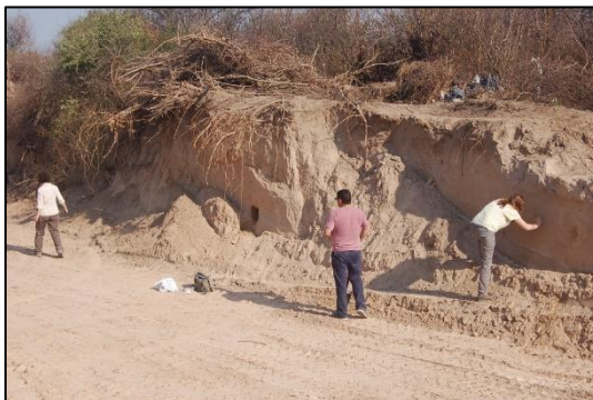
Figura 6.2. Talud en corte. Ubicación: Italia esq. Salta. Depósitos eólicos. Muestra TRH-3, prof. 2,00 m. Nivel freático no detectado.
