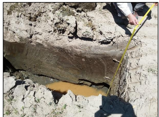
Figuras 6.4 y 6.5. Apertura de calicata exploratoria con máquina retroexcavadora. Ubicación: Chaco esq. Necochea. Depósitos fluviales. Muestra TRH-10, prof. 1,30 m. Prof. NF: 2,00 m.
