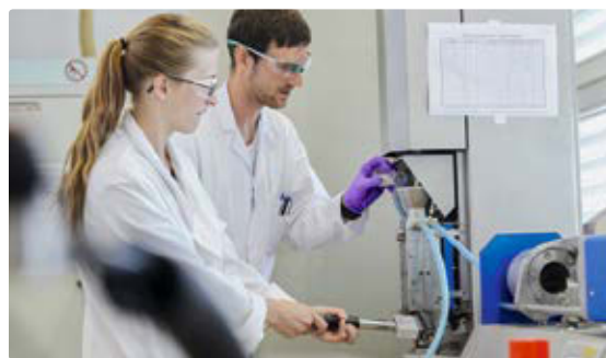
Erzeugung ligninbasierter Filamentmuster am Micro-Compounder
