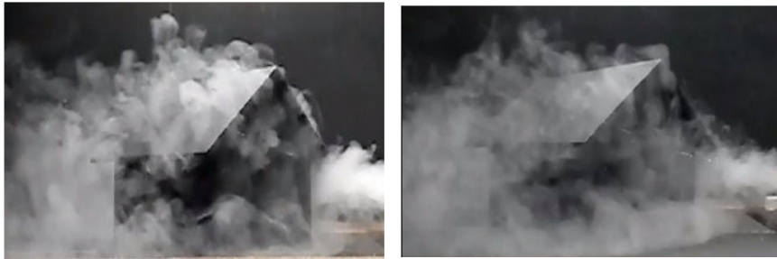
Figura 2 – Vista lateral do escoamento incidindo a \theta = 45^\circ : (a - esquerda) Re = 4591 e (b - direita) Re = 8801 .
