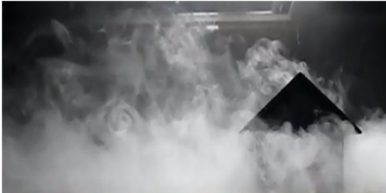
Figura 6. Vista lateral dos vórtices ferraduras na face esquerda e região de esteira próxima: \theta = 90^\circ e Re = 4591 .
