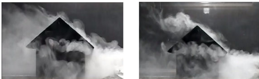
Figura 3. Vista lateral do escoamento incidindo a \theta = 90^\circ : (a - esquerda) Re = 4591 e (b - direita) Re = 8801 .
