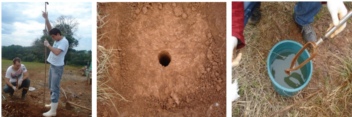
Figura 2. Tradagem efetuada no aterro sanitário em Seberi - RS, utilizando trado manual Sonda terra com 3 metros de haste (a), local de tradagem (b) e limpeza do trado em água destilada (c), Seberi - RS, 2012.
