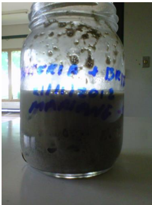
Figura 3. Remediação com carbonatos, brita e fluido de bateria.
