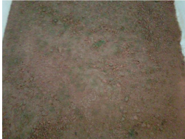
Figura 1. Surgimento de micro-organismos (algas de vida livre na superfície do solo) e bioaumentação de Fusarium moliniforme nas amostras de material de construção.
